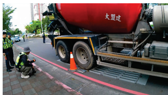
圖 7 預拌車中間輪靜止於磅片上
