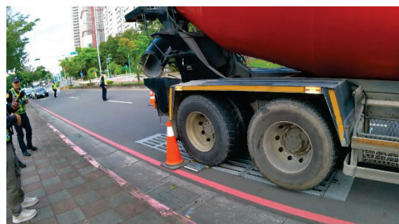
圖 8 預拌車後輪靜止於磅片上
