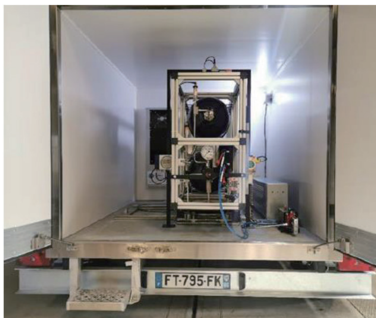
圖 4 CESAME-EXADEBIT 加氫站移動式原級稱重法標準系統[1]
