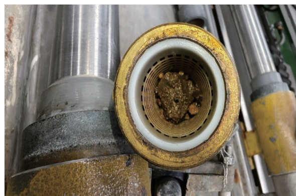
圖 2 水量計入水口濾網上的碎石
