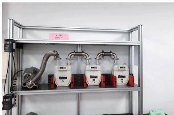
圖 2 2000 小時耐久性測試設備
