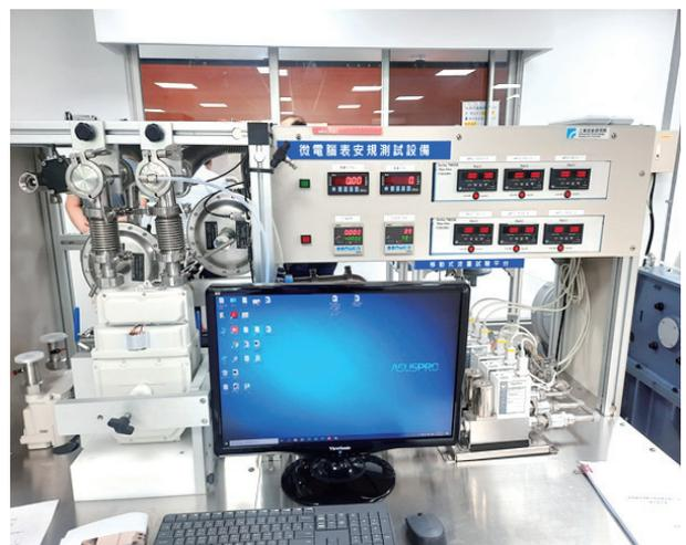
圖 3 微電腦膜式氣量計安規測試設備
