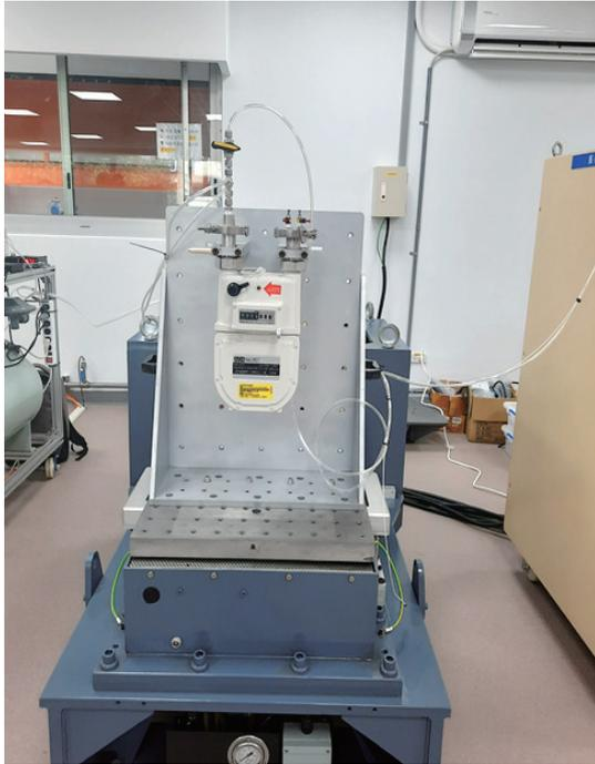
圖 5 振動測試設備
