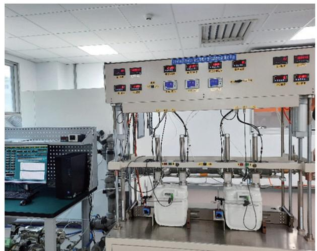
圖 1 計量性能測試設備
