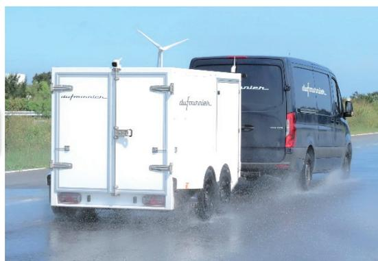
圖 2 輪胎濕地抓地力試驗方法
