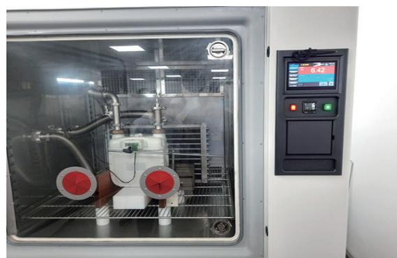
圖 4 溫濕度環境測試設備
