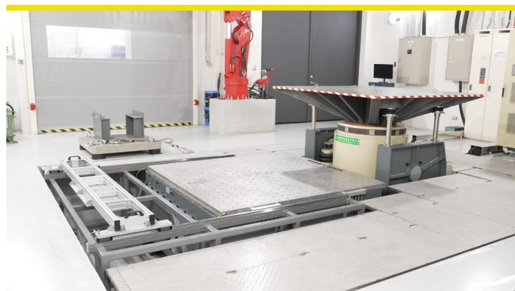
振動試驗系統
