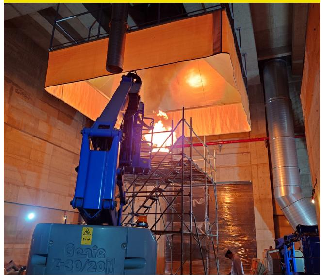
國內最大型的 10 MW 儲能設備防火試驗量測系統是檢測中心的主要亮點
