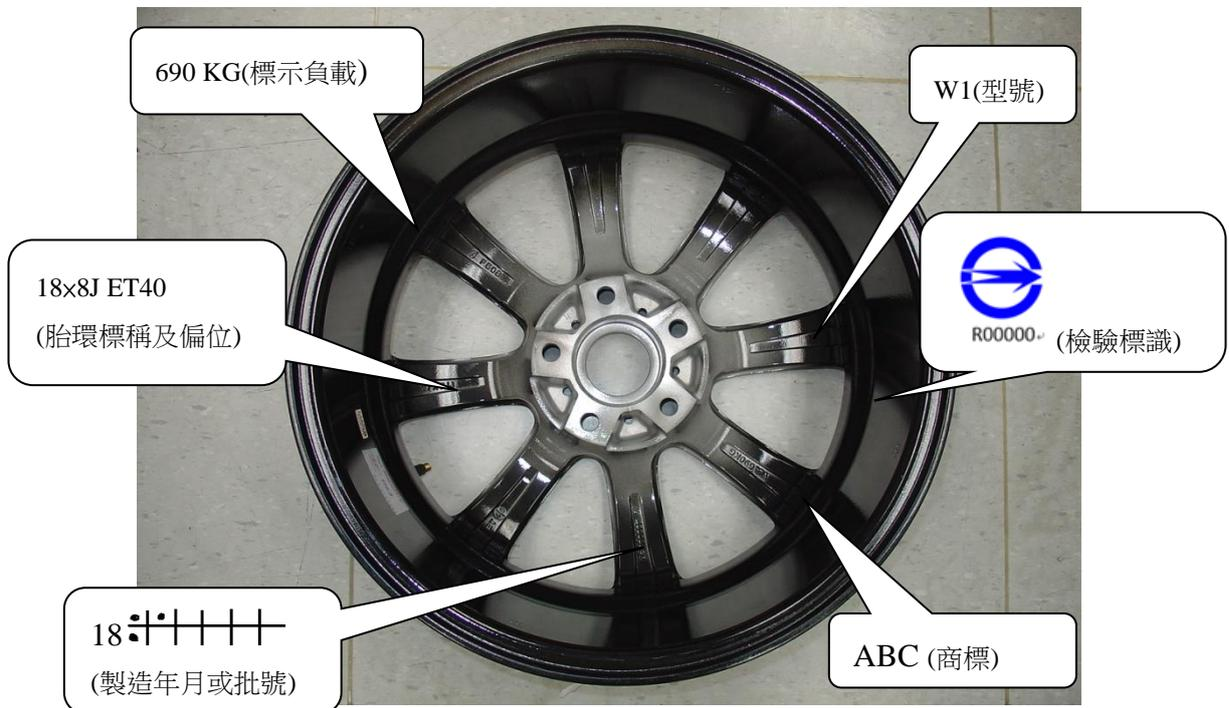
9. 輪圈結構圖【請提供 A4 大小工程圖示並標示全尺寸且圖文必須清晰】
