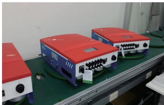
圖9 太陽光電變流器生產線組裝情形
