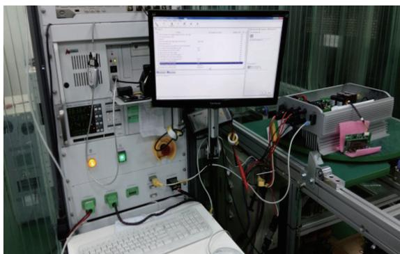
圖8 太陽光電變流器成品功能測試狀況
