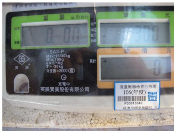
圖3 抽檢該攤商新購置電子式計價秤，均符合度量衡法規之規範，於本體貼上檢查合格單。
