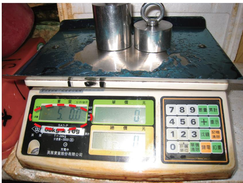
圖1 攤商使用改造之電子式計價秤，本體貼有「60 kg × 10 g白底黑字」標籤，涉違反度量衡法。
