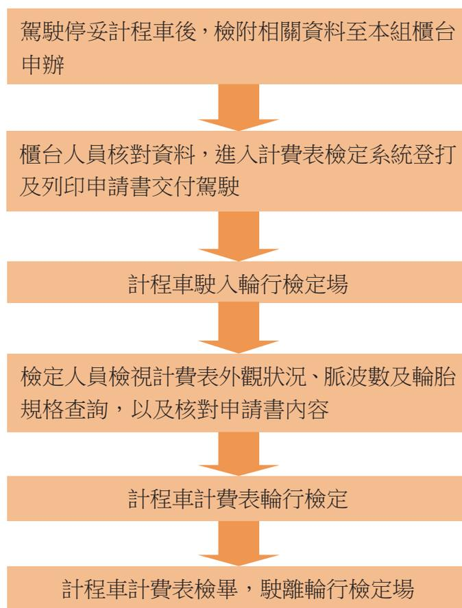
圖 2 國內計程車計費表輪行檢定作業流程
