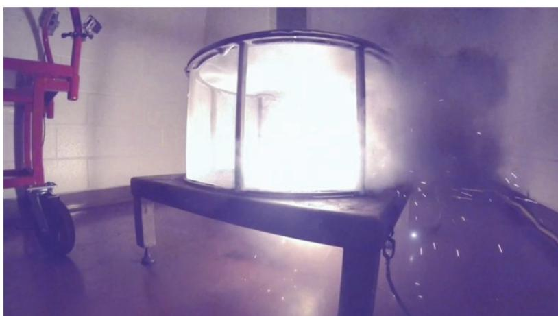
圖 3 燒射測試機
