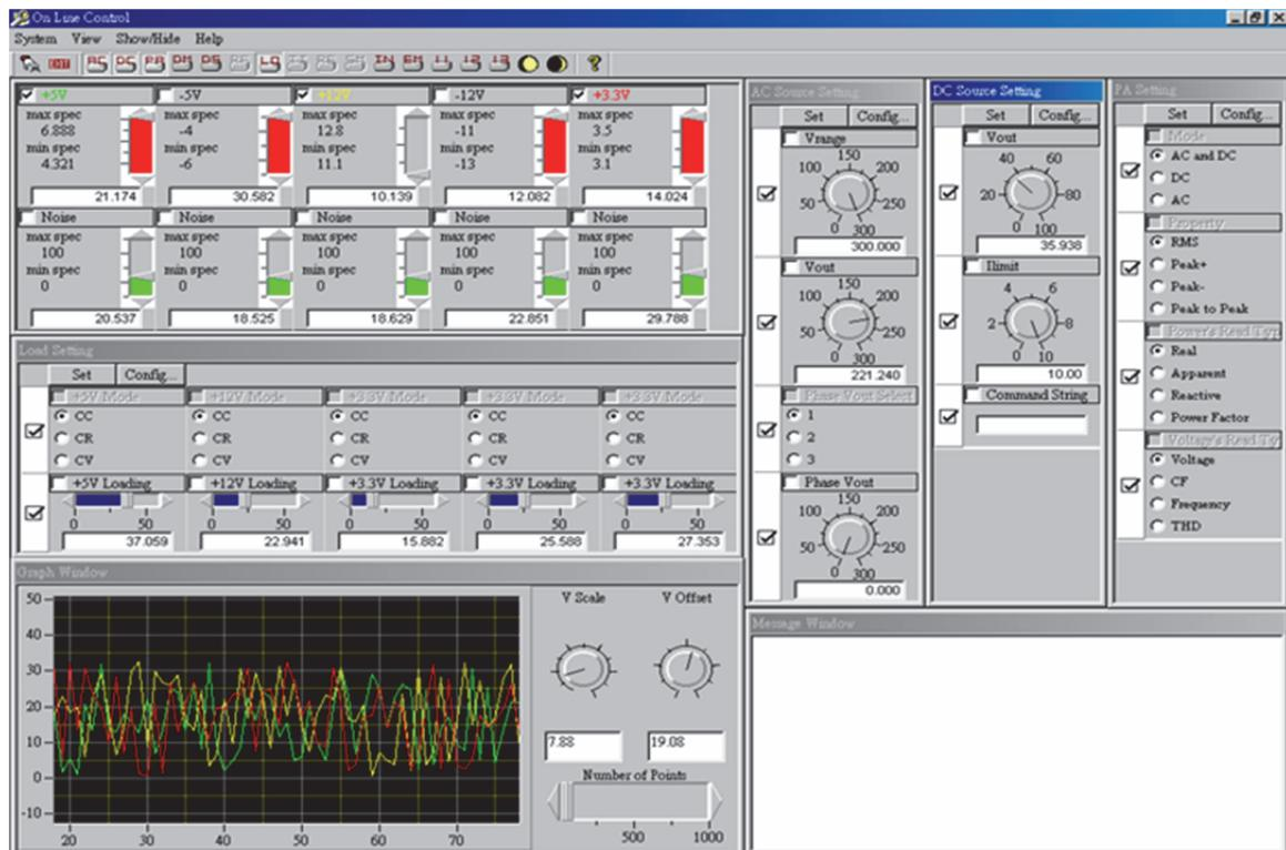
圖 3 併網試驗控制軟體及波形圖
