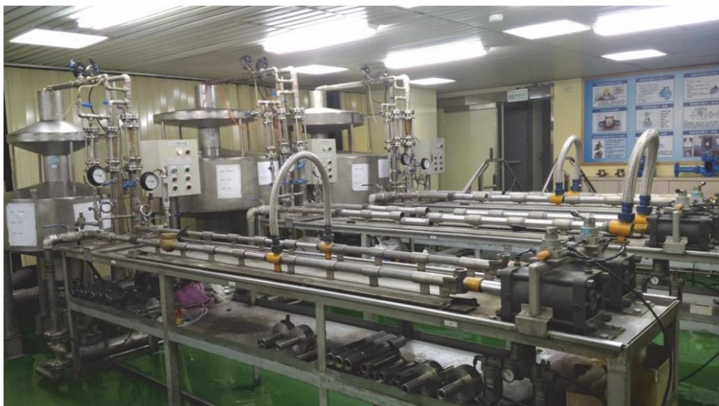
圖 7 測試實驗室水量計測試平臺設置情形
