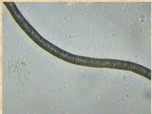
Fig. S7-2 Nylon標準布纖維200X穿透式圖像
