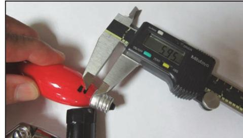
(f)燈座空間絕緣距離量測 5.95 mm
