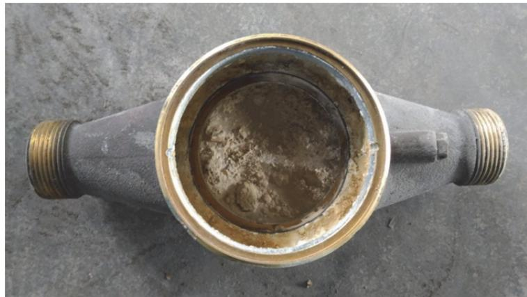
圖 1 細微泥沙沉積於水量計內部情形
