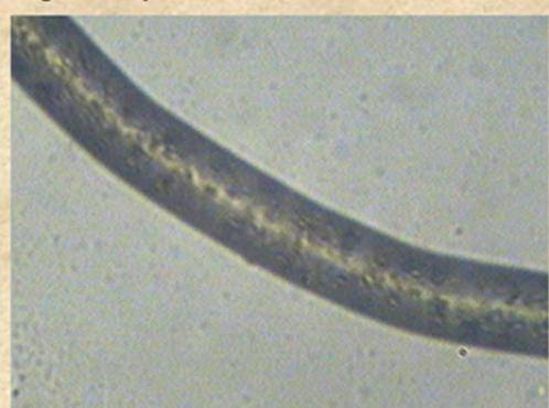
Fig. S7-3 Nylon標準布纖維500X穿透式圖像
