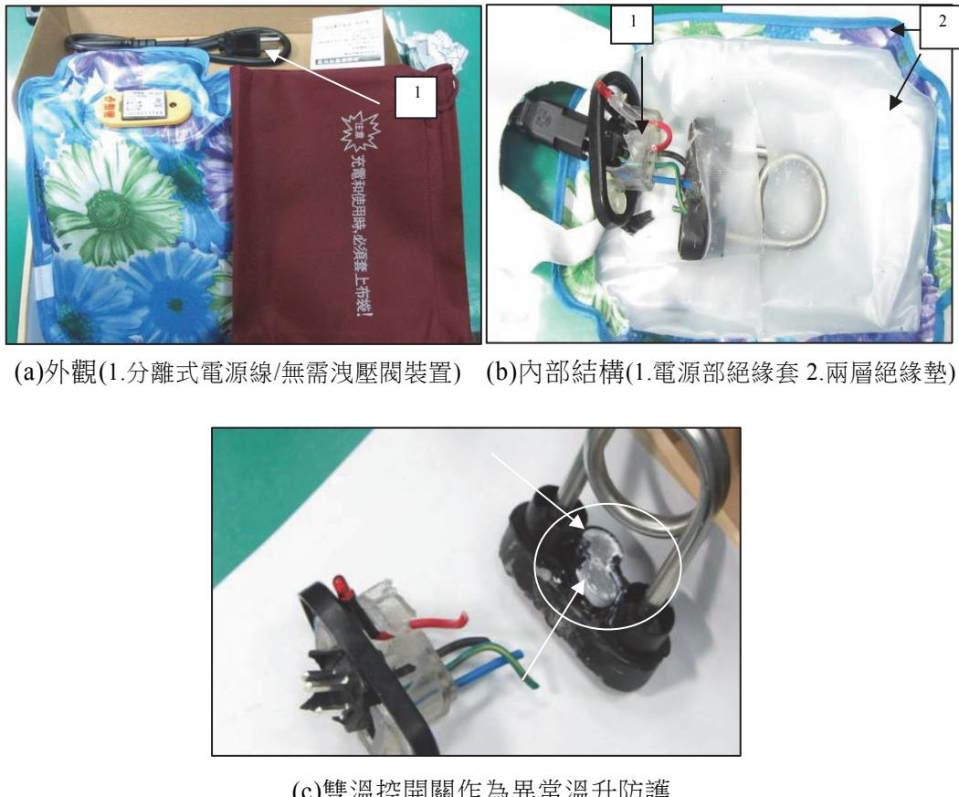
圖 3 電湯匙型電暖水袋之外觀、內部結構、零組件特寫(合格樣品)
