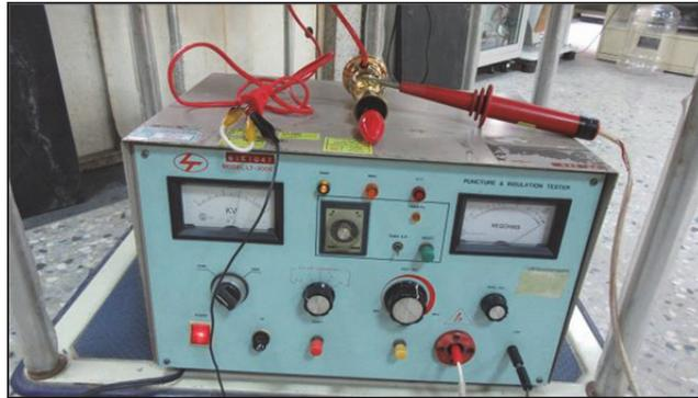
圖 4 神明燈的絕緣耐電壓測試
