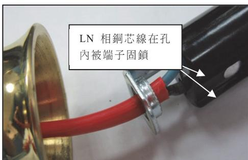
(c)4.7 節燈座提供電線芯線固定孔，銅絲無外露
