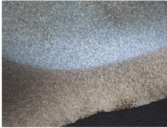
圖1 水淬鋼筋金相圖(25倍)
