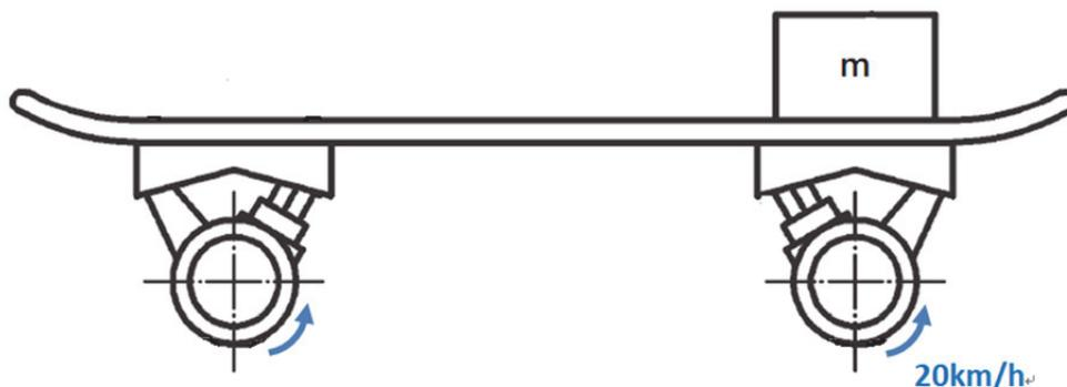
圖 8 滑板速度試驗示意圖
