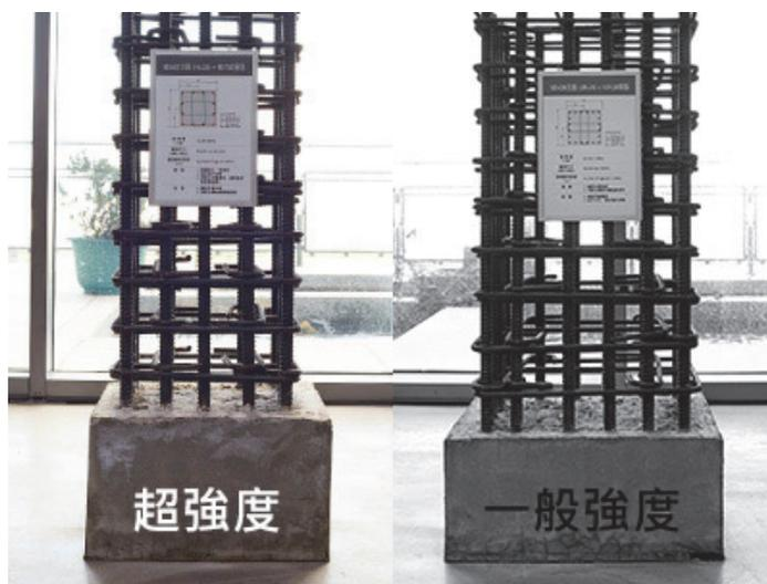
圖 1 高強度與一般鋼筋於建築結構之使用量圖示
