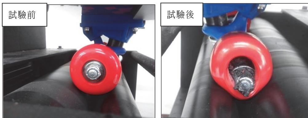
圖 10 速度試驗檢測不合格案例
