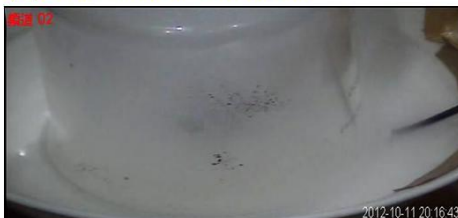
圖 15 分壓電容模擬試驗發生燃燒前，開始冒煙
