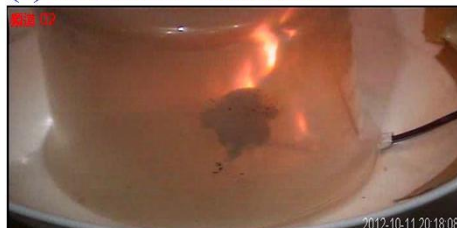
圖 16 分壓電容模擬試驗發生燃燒情形
