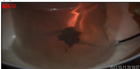
圖 16 分壓電容模擬試驗發生燃燒情形
