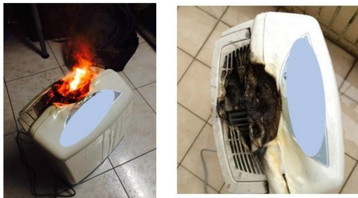
圖 5 輕微燒損的除濕機事故案例商品殘骸_案例 1 （左圖為事故發生時的燃燒情形，右圖為撲滅火勢後的燒損情形）
