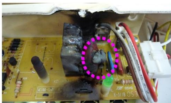
圖 19 除濕機事故通報案例樣品的分壓電容出現金屬薄膜熔出情形
