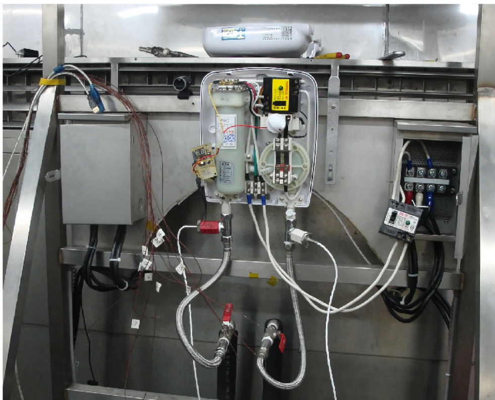
圖 25 電熱水器循環通/斷水試驗架
