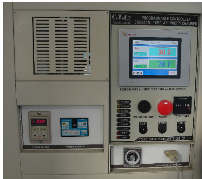
圖 20 步入式恆溫恆溼箱體附配之可程式化溫溼度控制器
