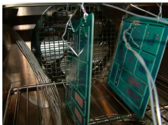
圖 12 PCB 板置於 USPCT 機台內並接上偏壓用導線 7
