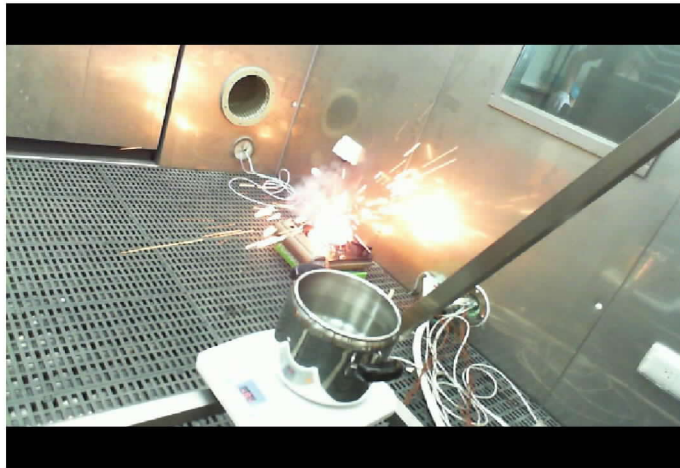
圖 24 模擬短路試驗之實況
