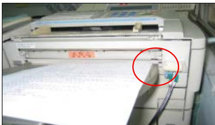
圖 7 上圖指針彎曲方式，一樣可讓紙張壓下
