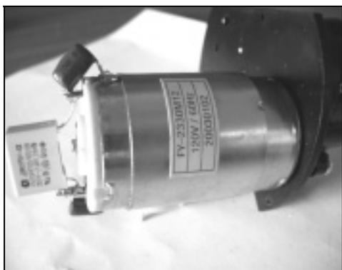
圖 1 標示 120V 實驗用直流馬達實體
