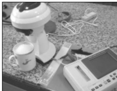
圖 14 刨冰機控冰量測情形
