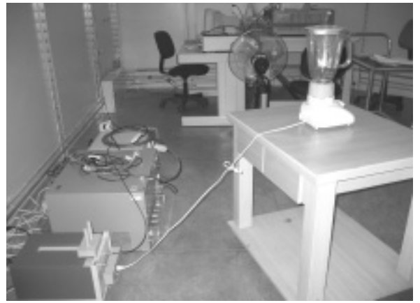
圖 8 作電壓干擾測試情形
