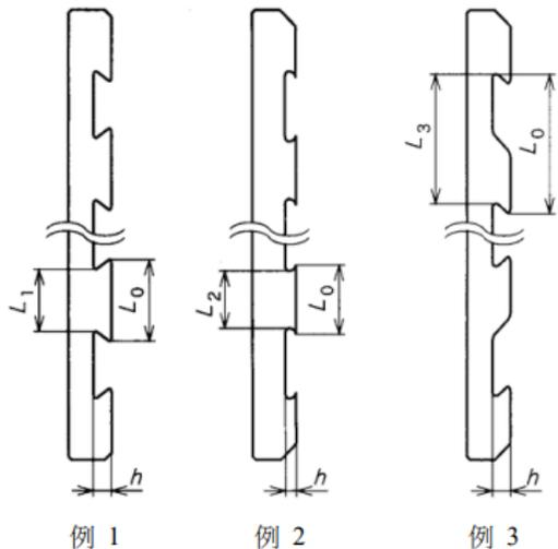
B. 背溝之深度：在製作尺度所訂定部分之背溝深度，須符合下表之基準。惟面磚之端部設有傾斜時，不包含該部分。
