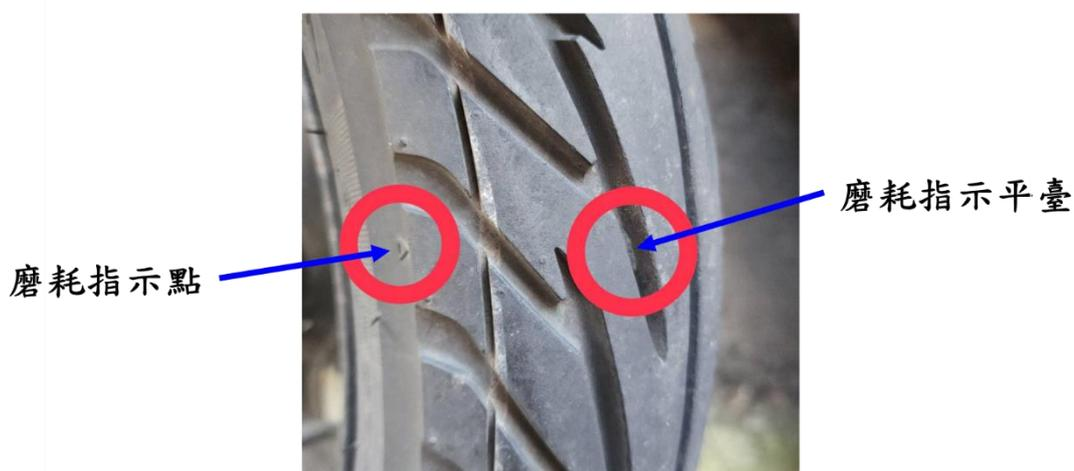
圖 2 輪胎磨耗指示點及磨耗指示平臺
