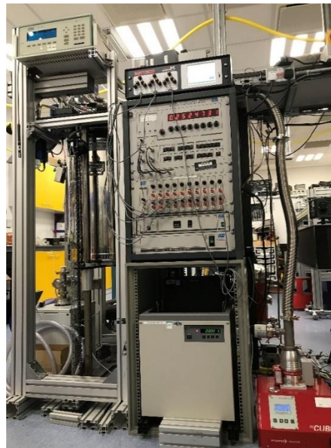
附二-圖 B10: 由左到右分別為 NPL 準球型共振腔聲學氣體溫度計右前側、右側、左側架構
