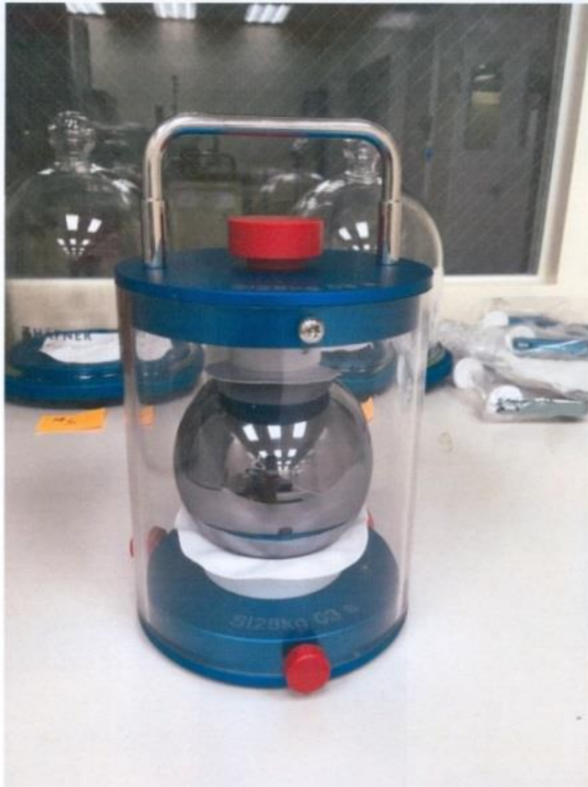
附圖 2. 砂 28 高度純化之 1kg 標稱質量砂晶球
