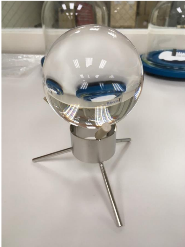
圖 4-19、置於矽晶球清洗架上之玻璃球
