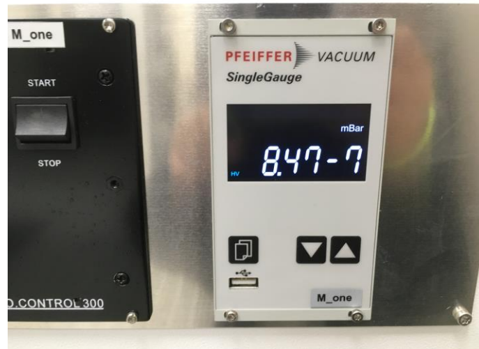
圖 4-30、真空度測試之真空計讀值符合規格
