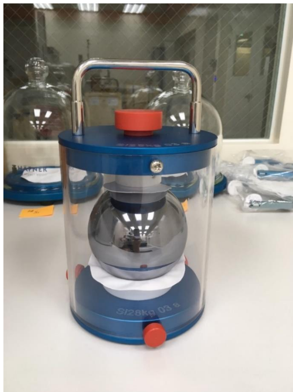
圖 4-6、矽 28 高度純化之 1 kg 標稱質量矽晶球(側視圖)
