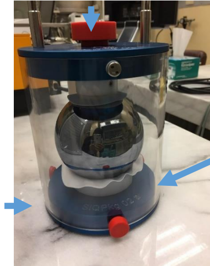
附二-圖 A4: 矽晶球儲存容器拆卸示意圖
