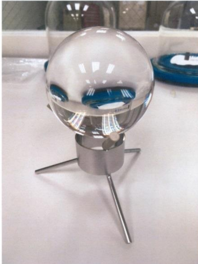
附圖 15. 置於矽晶球清洗架上之玻璃球。
