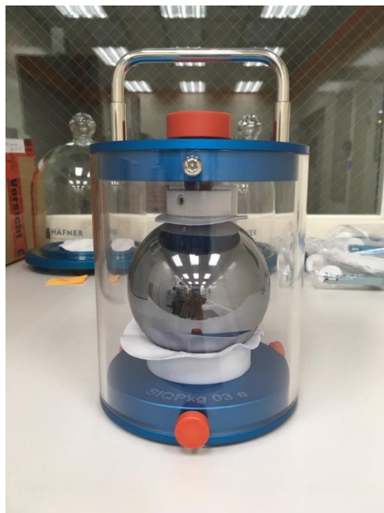
圖 4-15、準原級矽晶球(側視圖)
