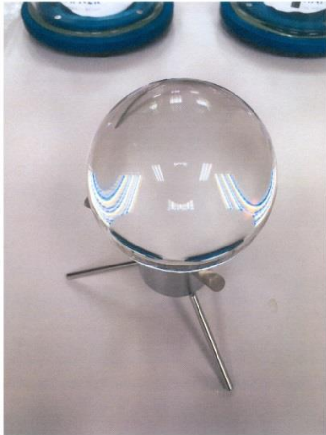
附圖 16. 置於矽晶球清洗架上之玻璃球。
