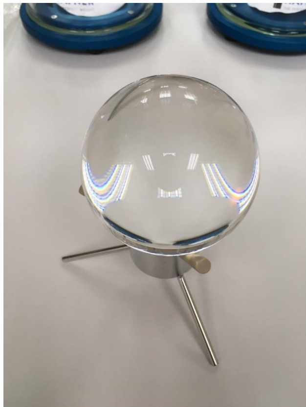
圖 4-20、置於矽晶球清洗架上之玻璃球
