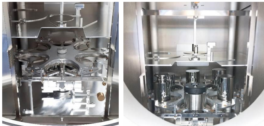
附一-圖 B3、6 個法碼承載位置之稱重轉盤
