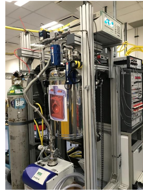
附二-圖 B10: 由左到右分別為 NPL 準球型共振腔聲學氣體溫度計右前側、右側、左側架構
