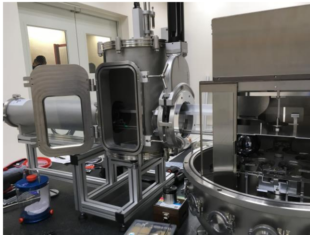
圖 4-26、進行矽晶球由 load lock 腔體傳送至質量比較儀上之位置測試
