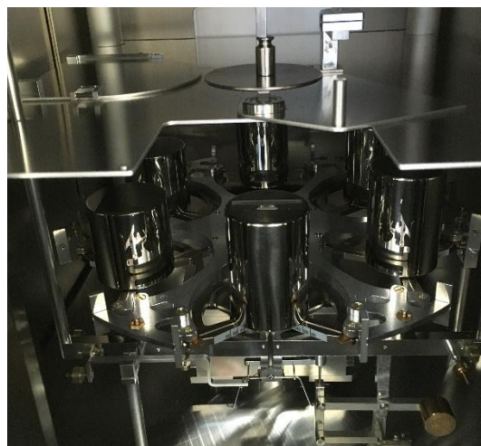
圖 4-28、轉盤上放置六顆 1 kg 不鏽鋼法碼與最上方 10 g 配重法碼
