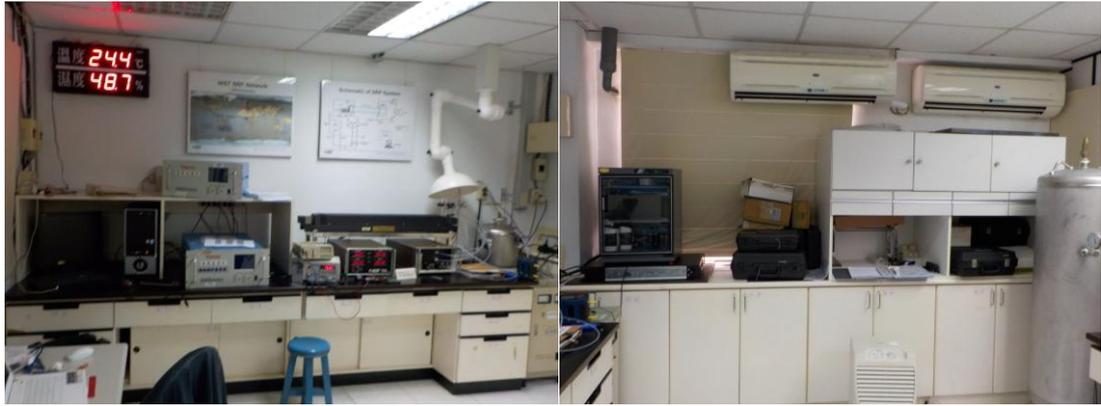
(a) 改造後（空間可同時設置兩套臭氧標準參考光度計，並增設一套加裝純化裝置之零級空氣供應設施）
