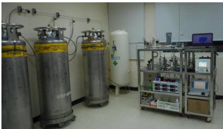
圖十一：簡易型微量水氣產生暨量測裝置硬體設備
