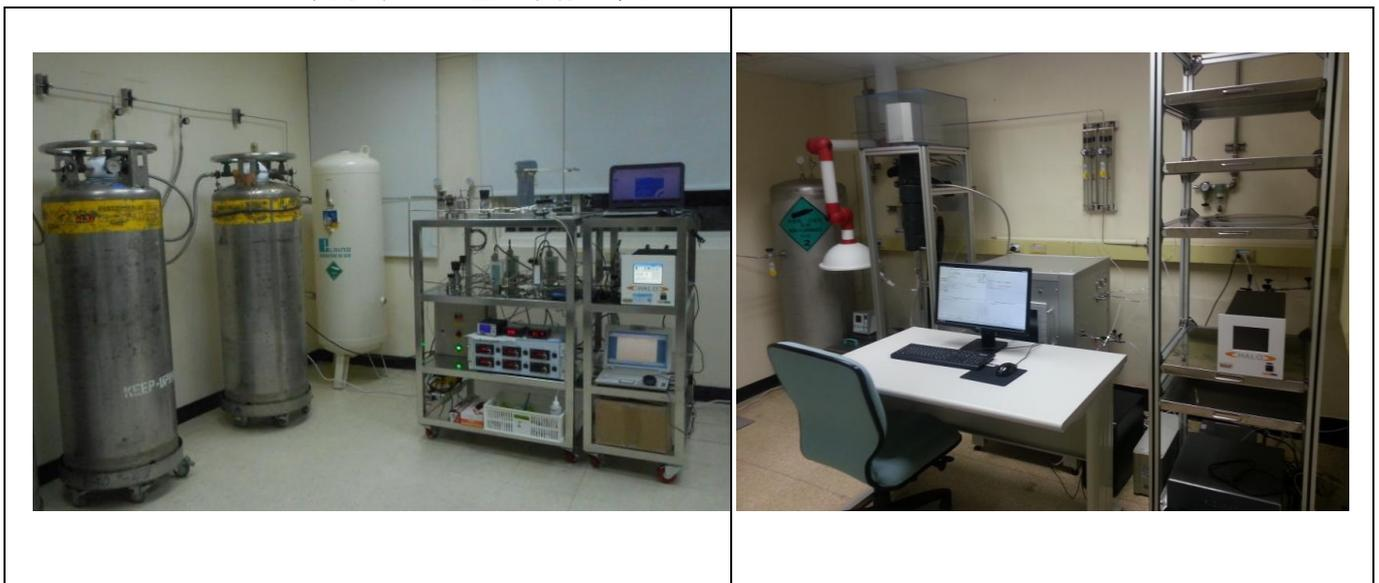
圖五：動態氣體配製暨量測技術整合系統（甲醛與微量水氣）
