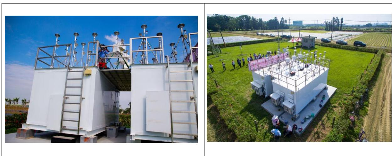
圖五十一：PM<sub>10</sub>&PM<sub>2.5</sub>懸浮微粒監測儀器比測平台規劃（與環保署跨部會合作）
