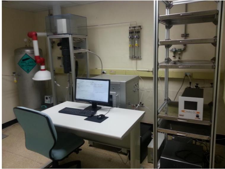
圖八：甲醛氣體計量標準系統照片
