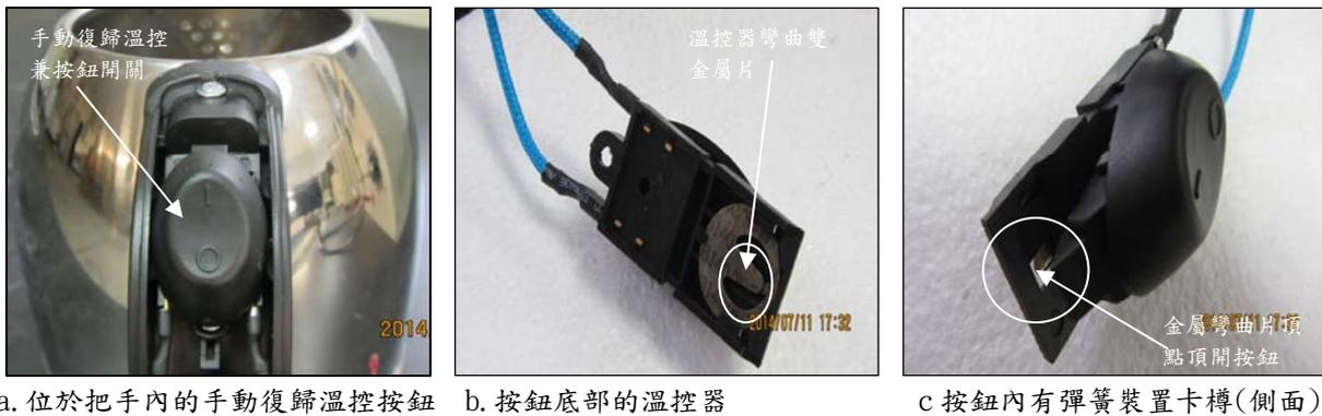
圖 3 手動溫控按鈕之動作原理 (購自樣品拆解)
