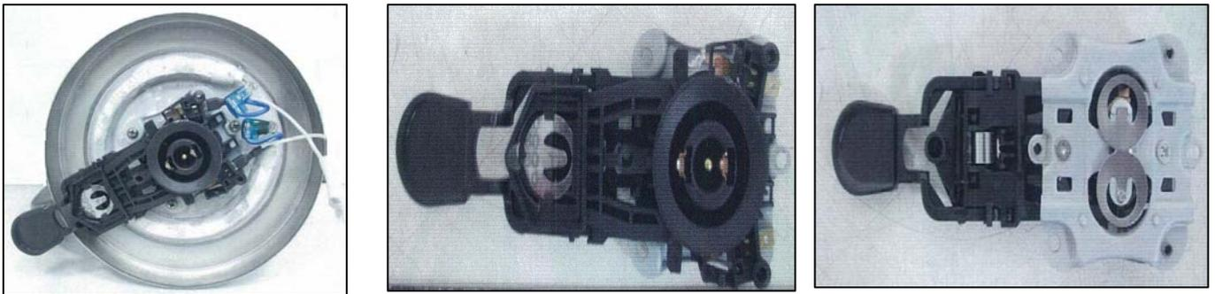
圖 5 手動與自動溫控的整合設計（購自樣品拆解）
