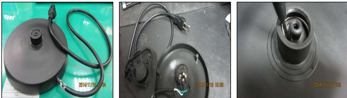
a. 無線電壺電源機座外觀      b. 內部 L 相, N 相, 接地 G 電性搭接      c. 電源機座蓋的供電結構: L (孔外邊), N (外環內邊), G (中孔)
