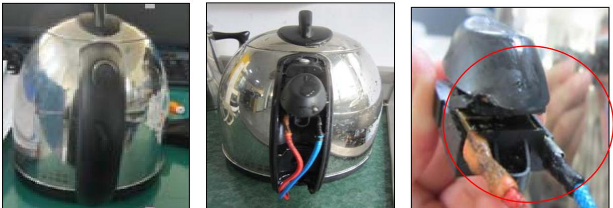
a. 手動復歸溫控按鈕過於接近壺蓋 b. 水位過滿沸騰溢出造成溫控失效 c. 持續加熱至低水位過程已發生內
