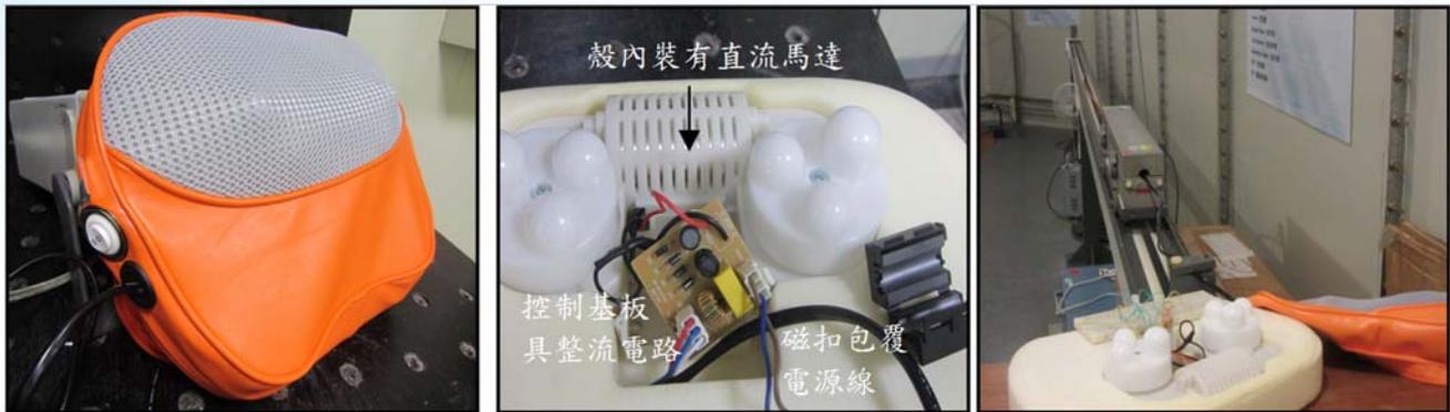
圖5 電動按摩枕本體、內部干擾源、拔除對策元件後作功率輻射
