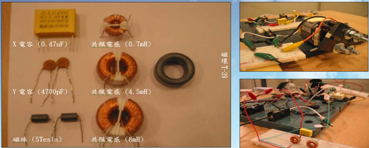
圖4 傳導性電壓干擾量測及投入對策元件選用規格
