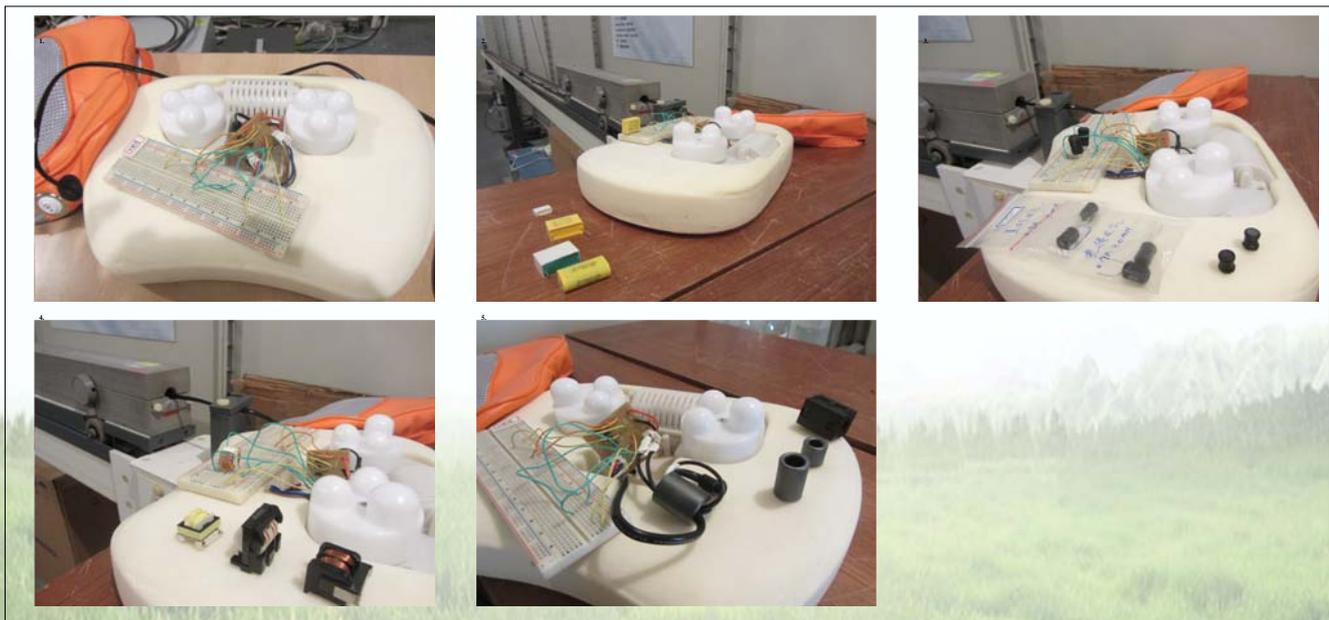
圖6 對策元件插件(1:拔除原先對策 2:X電容 3:差模電感 4:共模電感 5:磁環)
