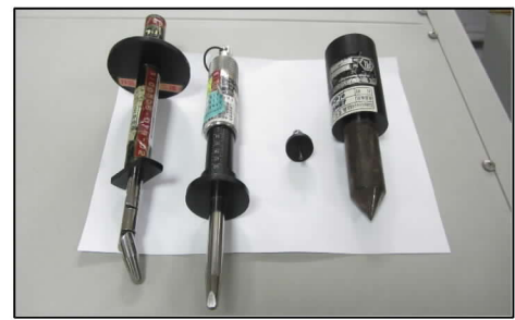
試驗指/具施力刻度之試驗指/試驗針/試驗棒(左至右)
