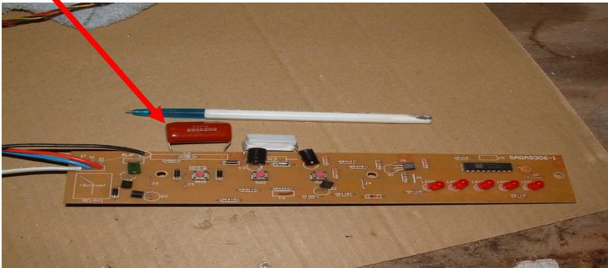
2.如平常順便維修可將問題電容圖(一)剪下，用電烙鐵 60W 用貼焊方法，焊上無問題電容一定要確實焊好如圖(二)
