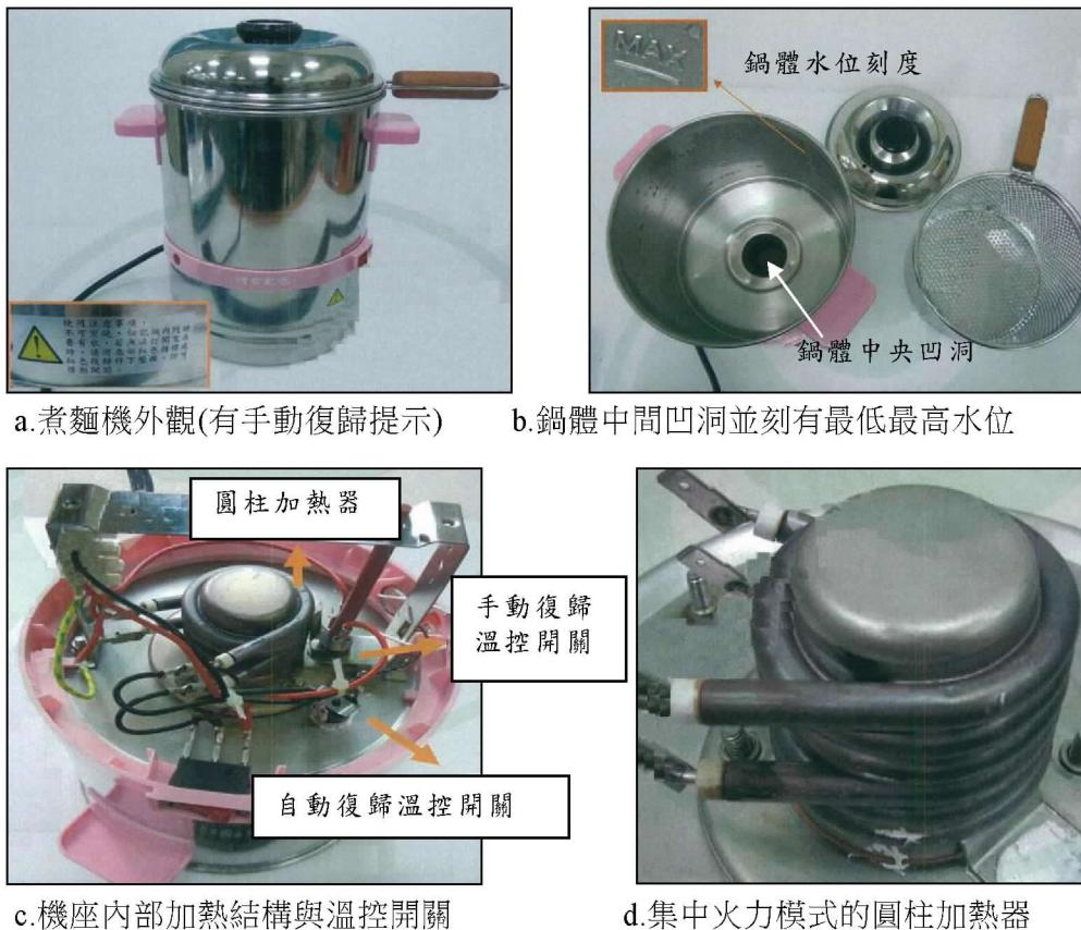
圖 15 電煮麵機結構與原理(1200W) (購自樣品拆解)
