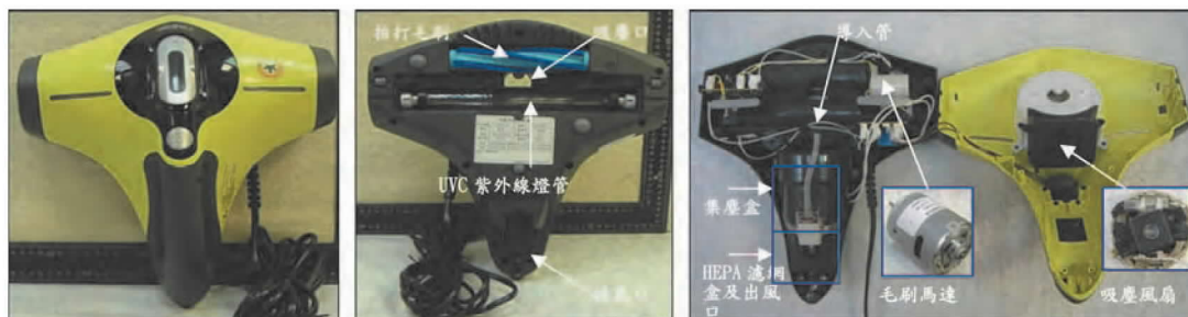
a.外觀 b 吸頭、拍打毛刷、UVC 燈 c.內部結構
