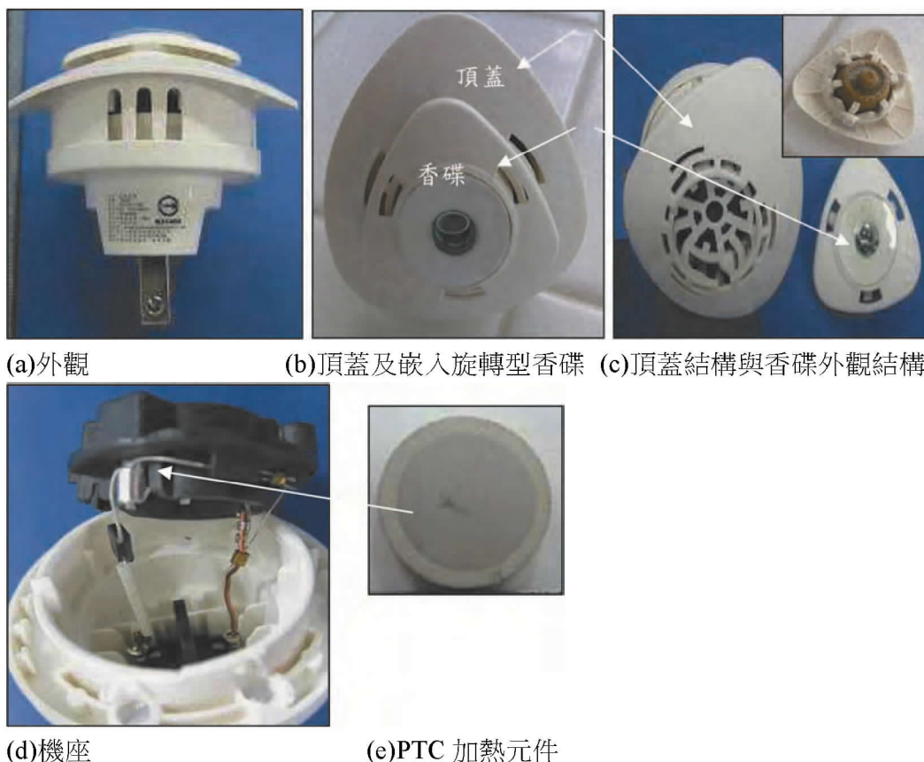
圖 1 電蚊香碟外觀與結構(實體樣品拆解)
