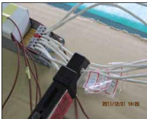
圖1 安定器七個輸出埠(量測燈絲電流)
