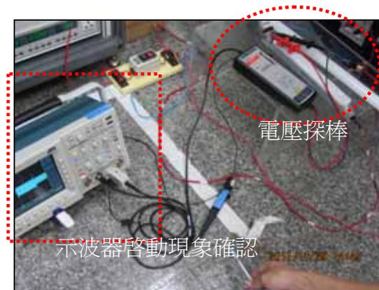
(A)示波器監測管電壓裝置圖
