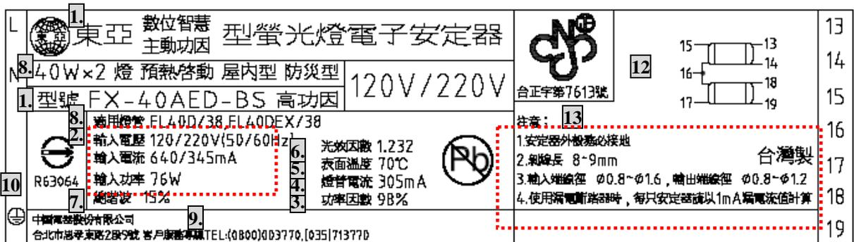
圖 4 40Wx2 適用電子式安定器實際標示情形
