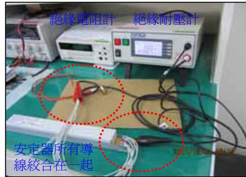
(B) 絕緣電阻與耐電壓計測試
