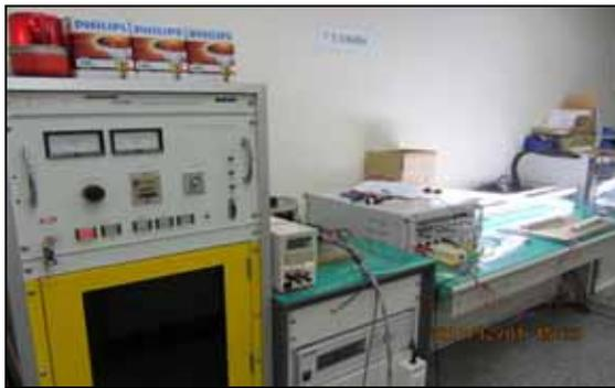
圖 10. 雷擊突波產生器
