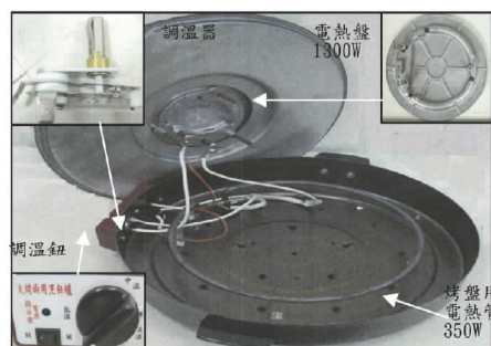
(b)機座內部電熱結構(調鈕與調溫器連動並串接電熱盤)
