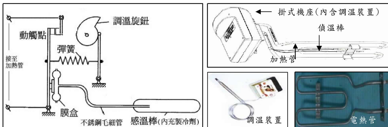
a.調溫裝置動作原理
