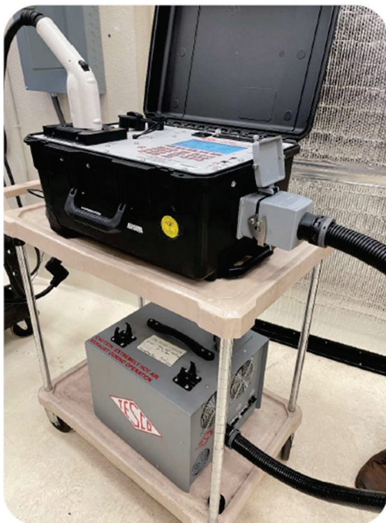
圖 2 加州充電樁檢測設備 (TESCO T4000 EVSE Tester 及 PL4000 Programmable AC Load Box)
