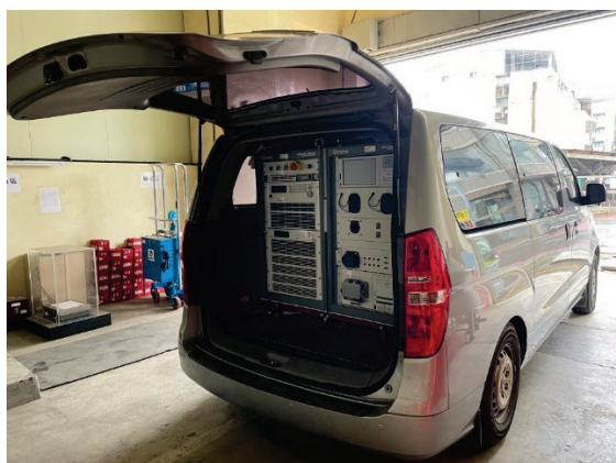
圖 4 充電樁檢定檢查設備固定於充電樁檢測車上
