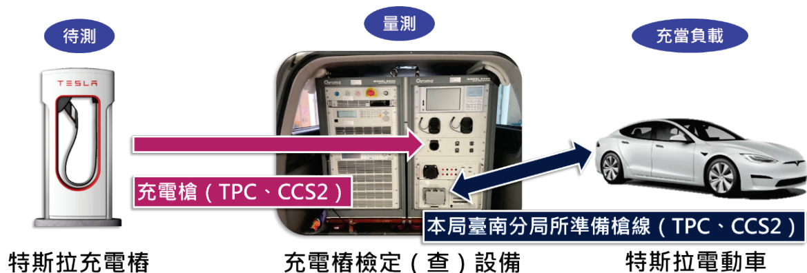
圖 6 特斯拉充電樁與檢定檢查設備連接方式
