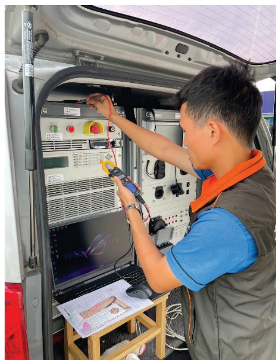
圖 5 使用三用電表確認無感電之虞
