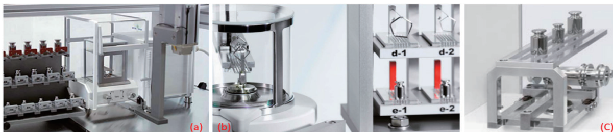
圖 2 (a)50 kg 以下法碼的自動對心稱盤；(b)自動對心盤主要元件；(c)1 噸以下法碼的自動對心稱盤，下方白色外環為防風框架圖例[6]
