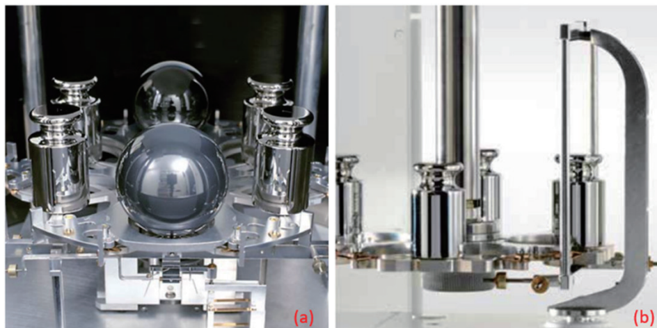
圖 4 (a) 6 個位置可放置矽晶球的自動盤，中間前後為矽晶球；(b) 4 個位置的自動轉盤與懸吊式稱盤（右側）圖例[6] [8]
