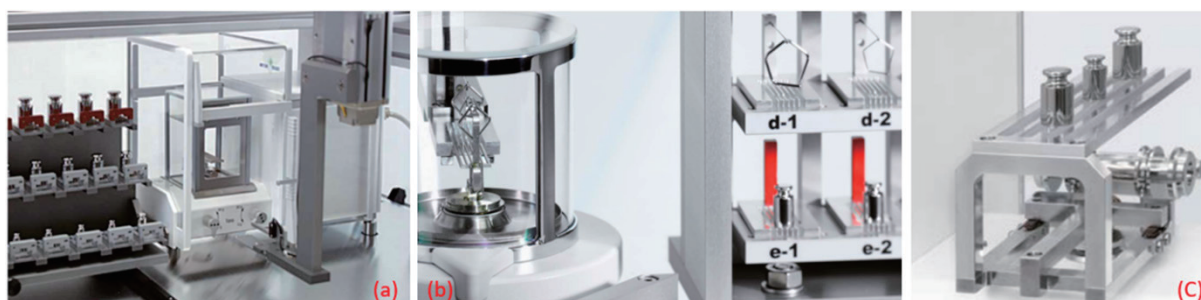
圖 5 (a)機械手臂質量比較儀中法碼架、比較儀、機器手臂[9]；(b) mg 法碼架與質量比較儀的懸吊式稱盤；(c)法碼架上擺放多個法碼，可以輕鬆完成法碼導引與組合校正圖例[6]
