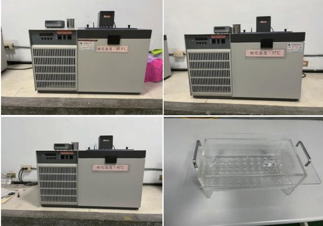
圖2 本局第七組執行體溫計檢定的檢定設備
