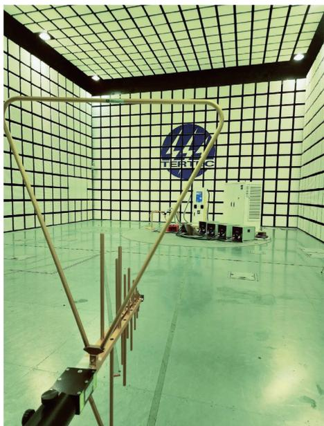
圖1 MW級智慧變流器電磁相容測試地
