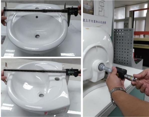
圖5 陶瓷臉盆尺度量測
