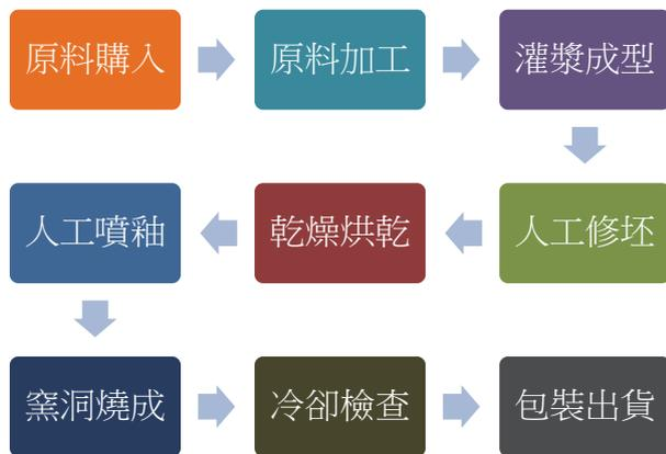
圖1 陶瓷臉盆生產流程
