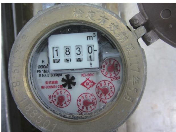
圖1 水量計積算面盤
