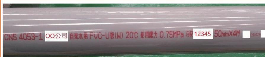
2、自來水用 PVC 管（CNS 4053-1）圖例
