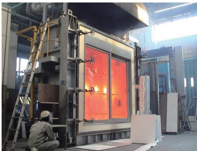
圖4 日本防火門實際測試過程[16]
