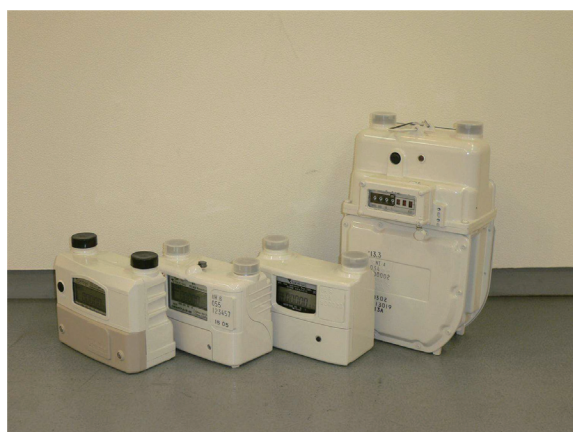
圖3 日本家用超音波氣量計實體與功能結構圖[4]
