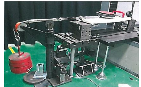
托架靜力強度測試
