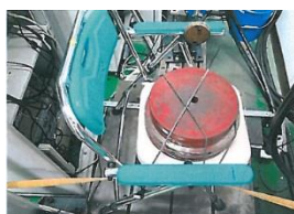
扶手水平方向耐久測試 (有扶手時)
