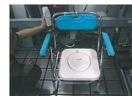
防頸部夾陷檢查測試 (有背靠與扶手時)
