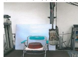
扶手耐衝擊測試 (有扶手時)
