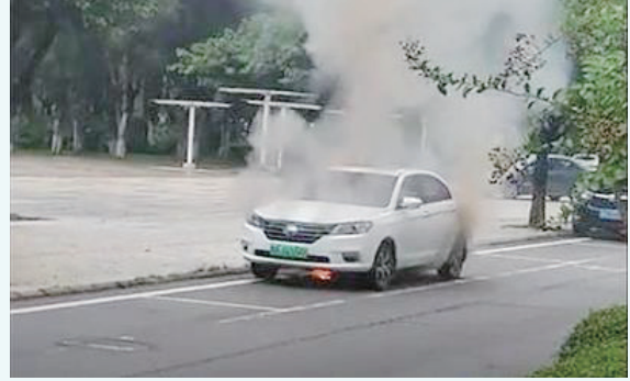
圖3 力帆650 EV起火現場，車輛在沒有有效滅火的情況下被火完全摧毀[16]
