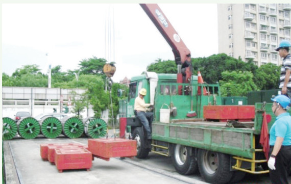
圖4 以標準法碼執行地秤檢定情形
