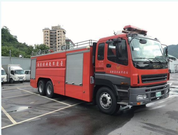
圖6 臺北市消防局水庫消防車（約 12,000公升水量）[24]
