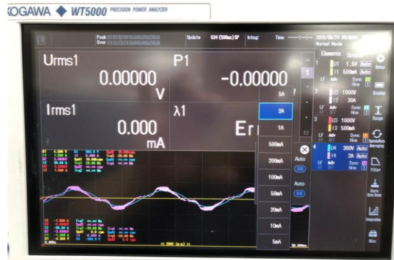
圖 2 具 7 檔以上量程及寬範圍電壓量測
