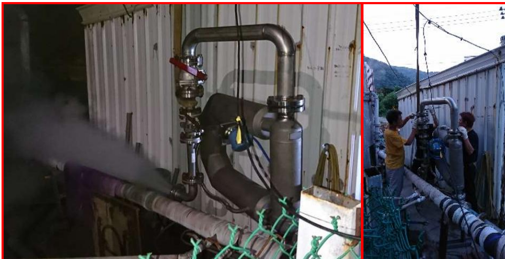
圖8、使用低頻科氏力量測計於臺東縣金崙地熱區溫泉井之流量量測(2019/6/19至2019/6/22)
