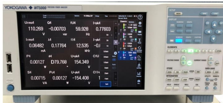
圖 3 搭配比流器後可大幅提高量測直流/交流電流範圍
