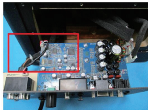
(b) 市購檢驗樣品無Ferrite Core
