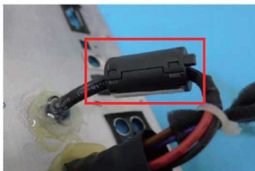
(a) 原始測試報告樣品有加1顆Ferrite Core
