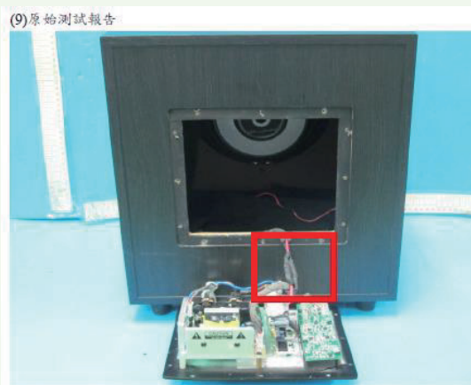
(a) 原始測試報告樣品有加2顆電感
