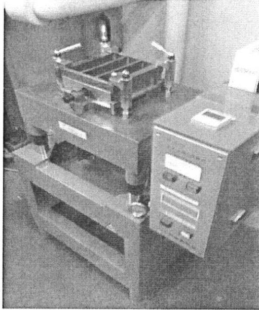
圖 9：日本執行水泥砂漿試樣填充所使用儀器
