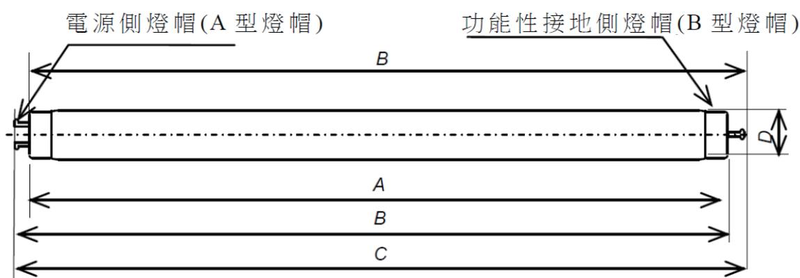
圖2 GX16t-5燈管尺度
