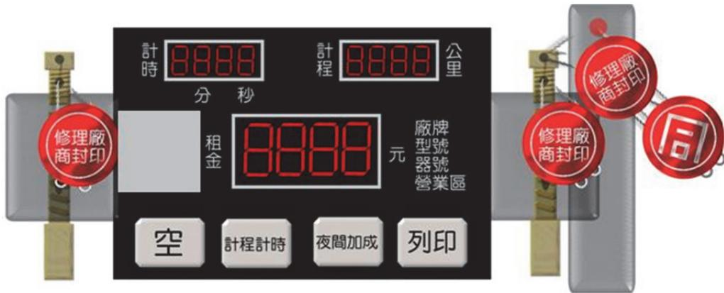
圖 6 計程車計費表塑膠封印使用情形示意圖
