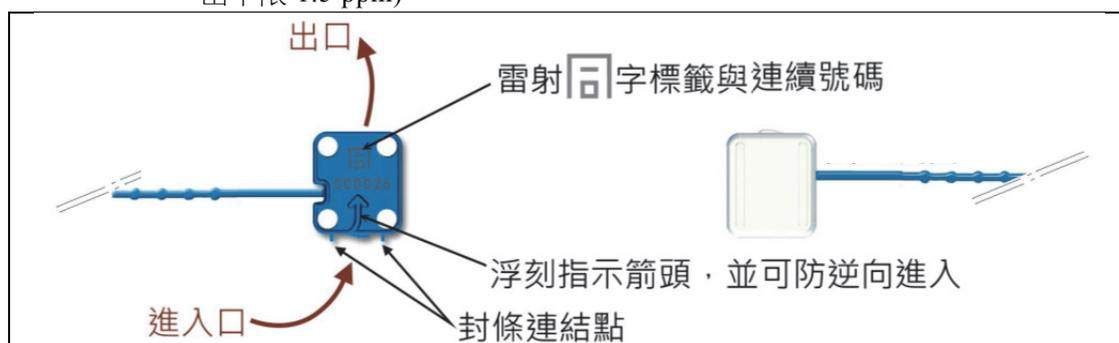
圖 3 油量計塑膠封印規格示意圖
