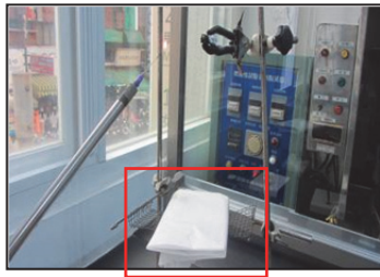
(a)針箴試驗設備(底下鋪棉紙)
