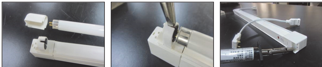
(a)測試前拔除可分離保護蓋 (b)以試驗指測試燈座縫隙 (c)測試串接擴充座帶電端子
