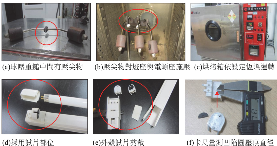
圖 8 耐熱測試與設備
