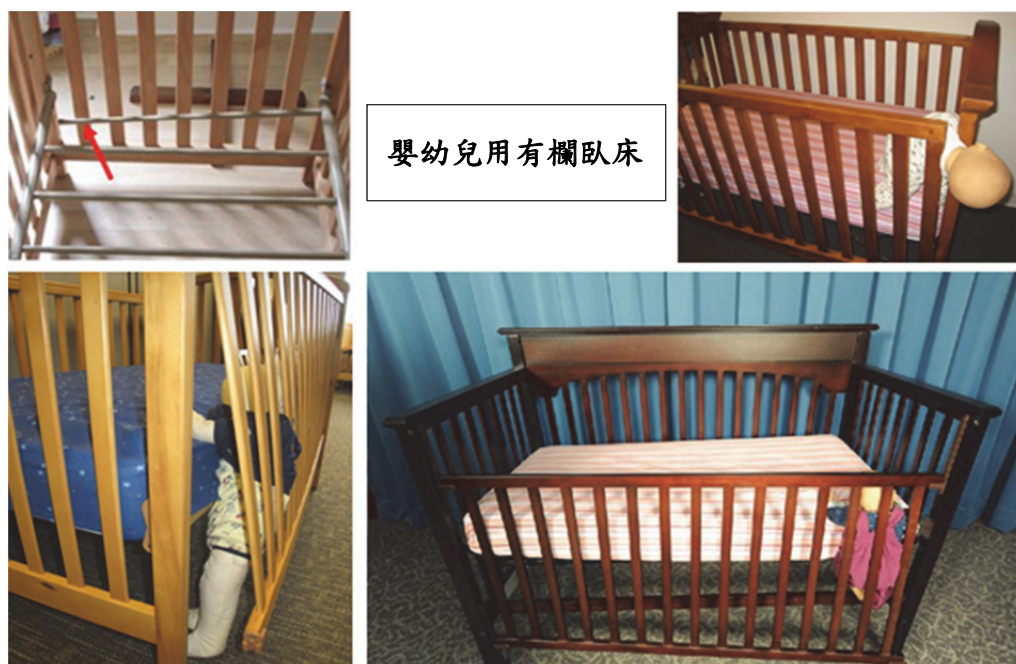
圖 9 嬰兒床床墊支撐硬體故障，膠合或螺栓連接失敗，板條完整性、側面門鎖失效以及導軌出牙脫落。
