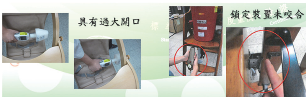
圖 7 兒童用高腳椅檢驗不合格情形
