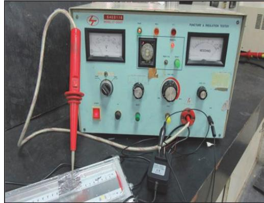
圖 8 絶緣耐電壓測試情形（耐電壓 500V）
