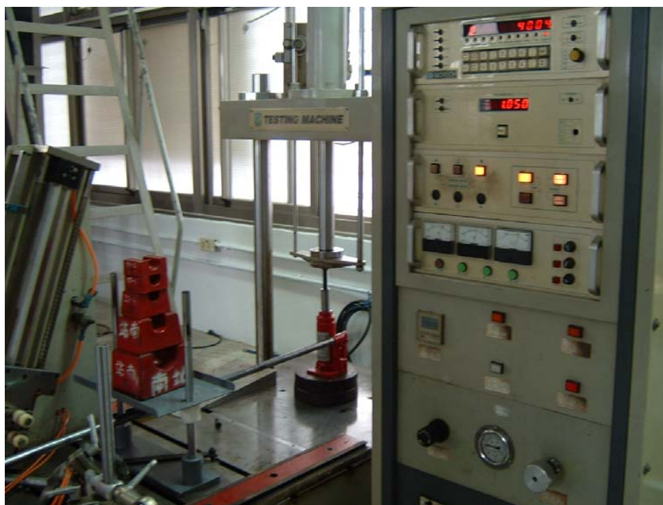
圖 3-2 5/10 噸千斤頂抗壓試驗機 (高鐵牌/ KT-F159) 與法碼荷重架
