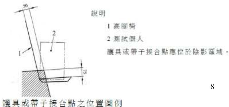
(5)所有束縛系統之組件，在最可能造成破壞方向，輪流對每一束縛系統零組件，在5s內逐步施加至150N之作用力，並保持1min.，應具有如預期的功能。
