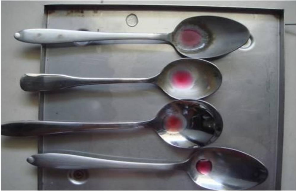
圖 7 電解檢測法硫酸溶液變色情形
