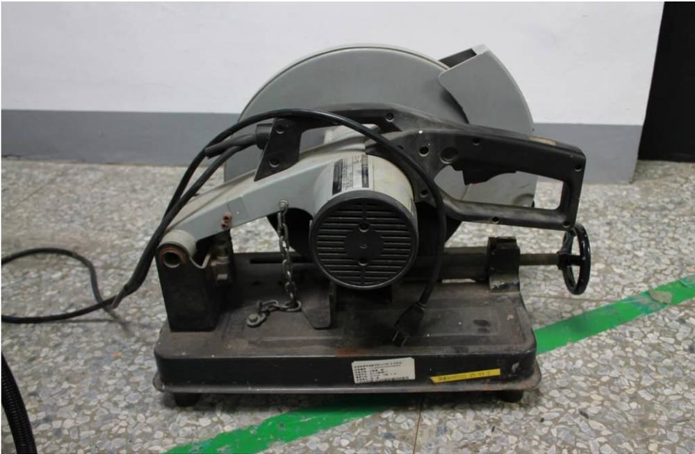
圖 14 砂輪切割機
