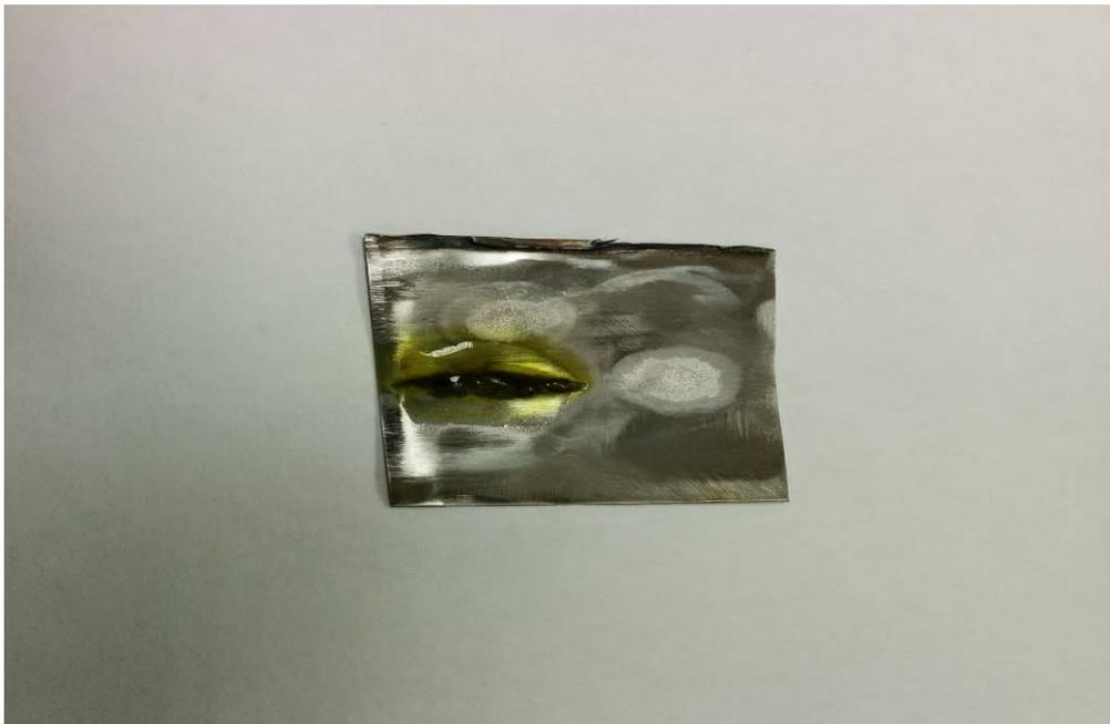
圖 22(a) 鹽酸+硝酸+試片(不銹鋼排氣管)
