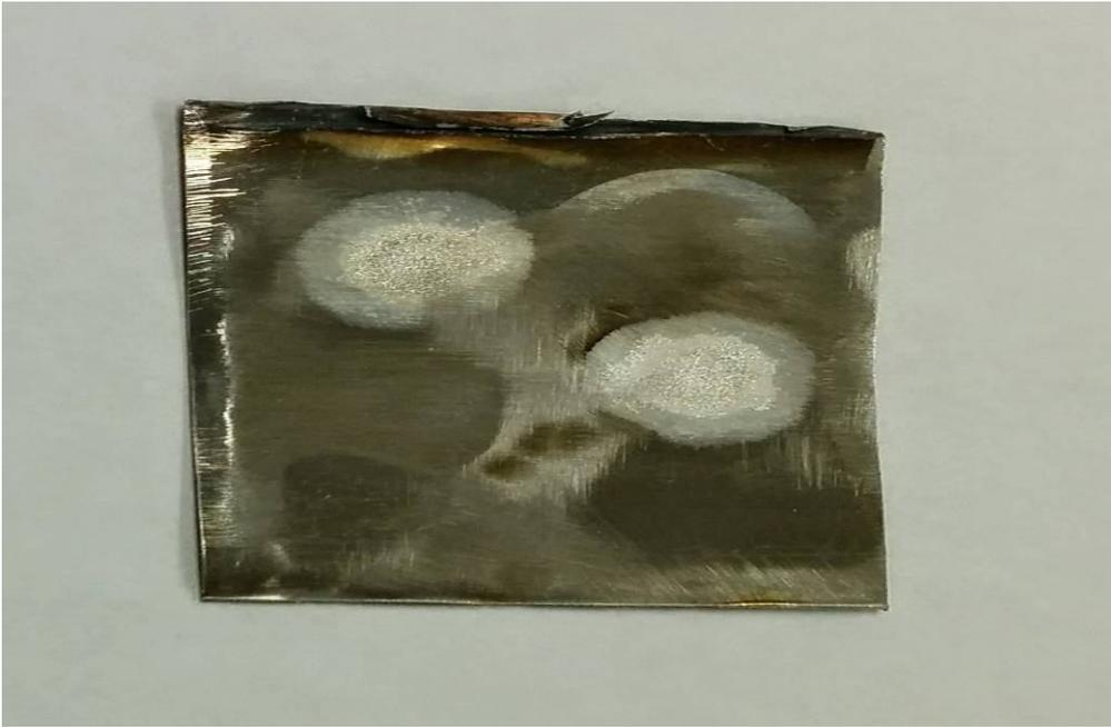
圖 19 熱水器不銹鋼排氣管樣品分析點
