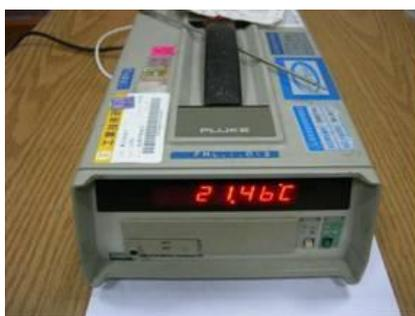
圖 4 FLUKE 溫度計
