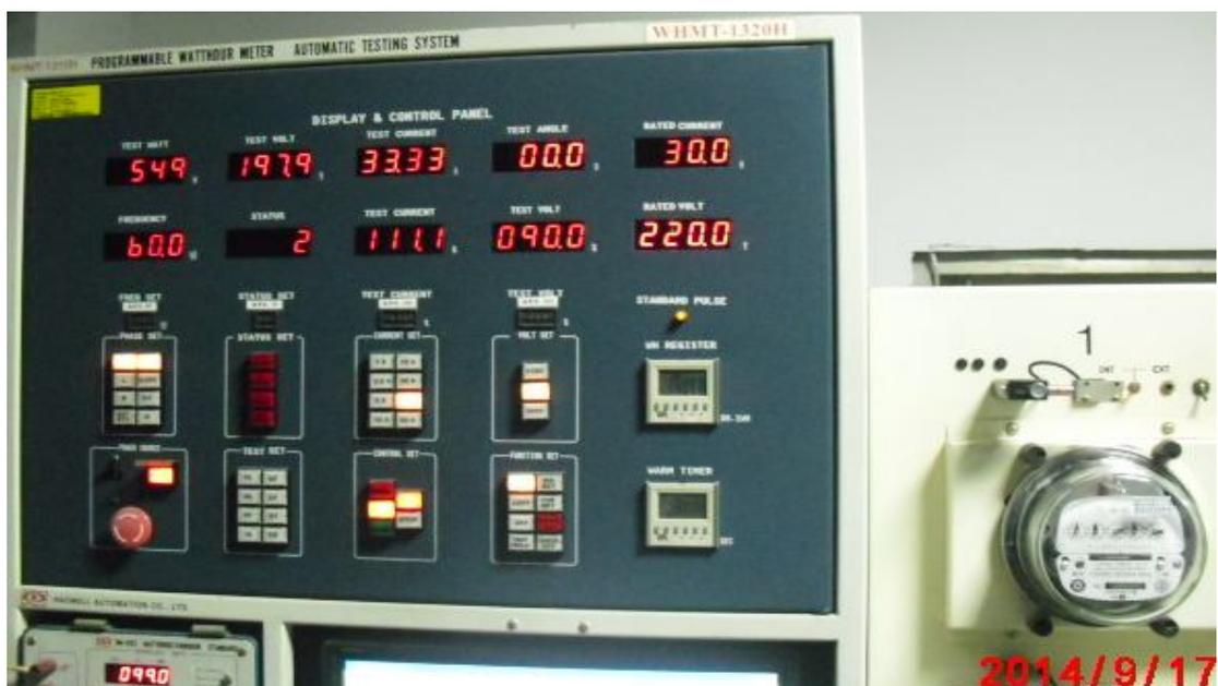
圖 4.10 0.9 倍額定電壓(198V,33.33A)定功率電表計量測試
