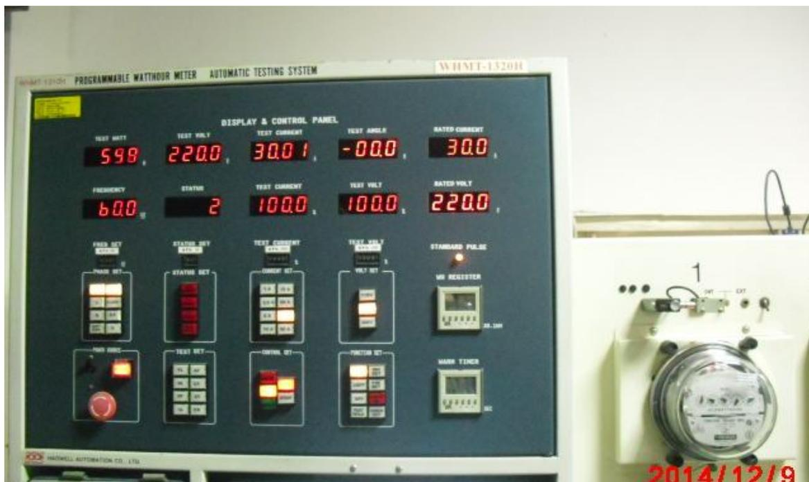
圖 4.8 100%額定電壓(220V,30A)定功率電表計量測試
